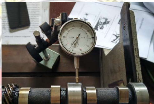
Gambar 3.13 Mengukur kelurusan camshaft
