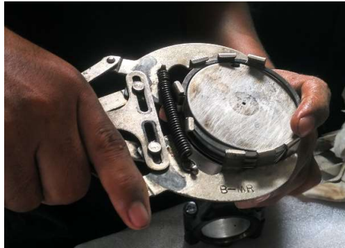
Gambar 3.23 memasang ring piston menggunakan ring expander
