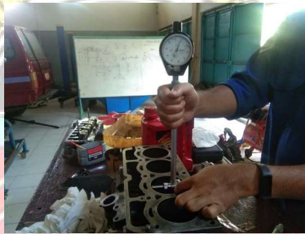
Gambar 3.18 Mengukur diameter silinder secara radial.
