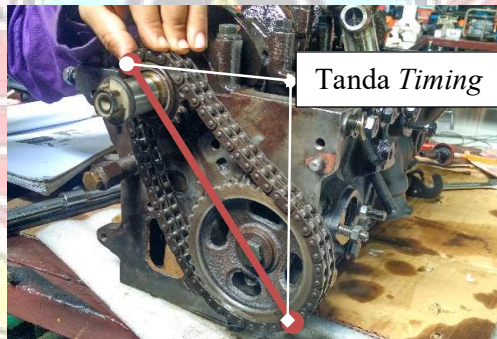
Gambar 3.27 Kelurusan penempatan rantai timing
