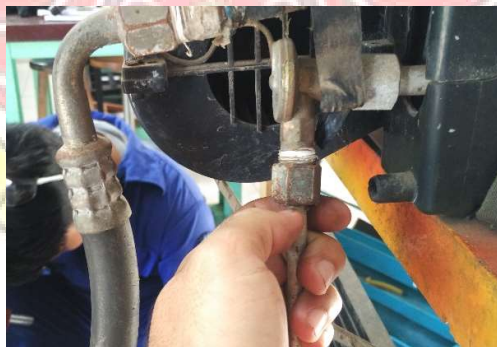
Gambar 3.2 Melepaskan hose pada expansion valve
