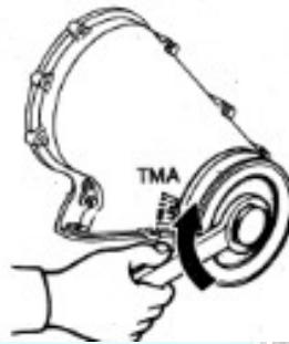
Gambar 3.32 Memutar piston ke posisi TMA silinder satu. (Sumber : Pedoman Reparasi Mesin Seri K)
