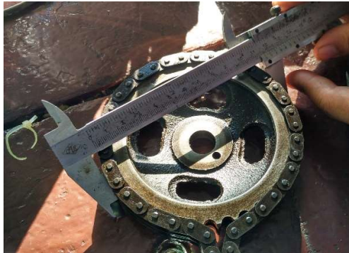
Gambar 3.12 Mengukur diameter roda gigi sproket camshaft .
