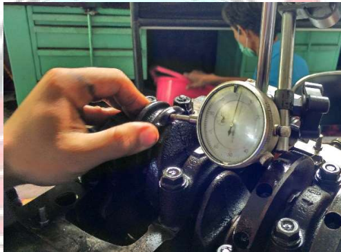
Gambar 3.16 Mengukur celah aksial batang torak.
