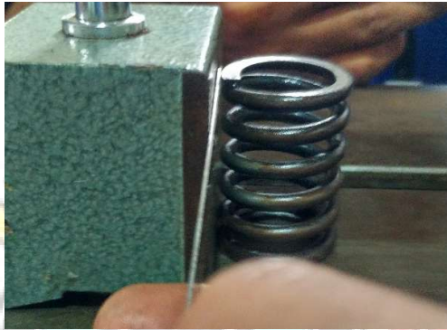
Gambar 3.11 Mengukur kelurusan pegas katup.
