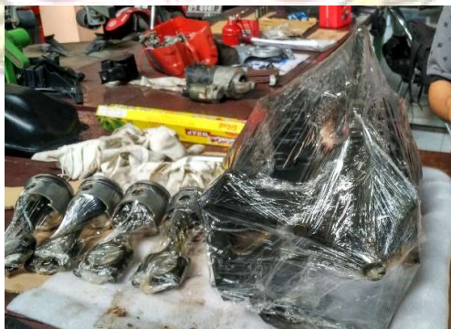
Gambar 3.21 Melakukan wrapping komponen mesin
