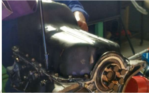
Gambar 3.28 Pemasangan oil pan
