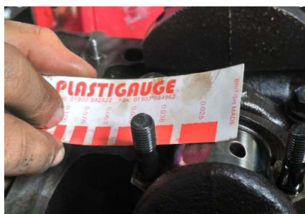
Gambar 3.19 Mengukur celah oli crankpin
