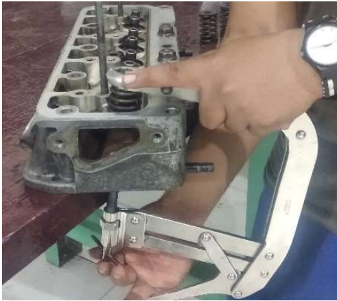
Gambar 3.7 Membuka katup menggunakan valve spring compressor
