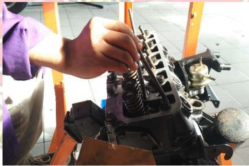
Gambar 3.29 pemasangan pengangkat katup
