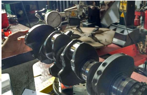
Gambar 3.20 Mengukur keolengan poros engkol
