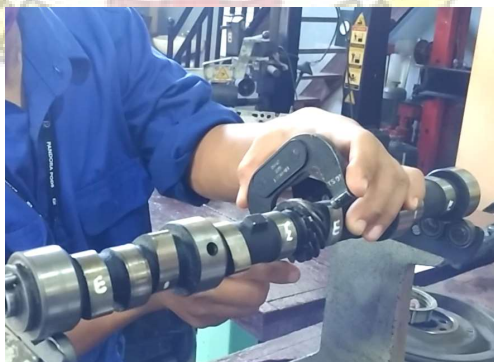
Gambar 3.14 Mengukur tinggi cam lobe .
