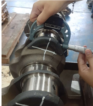
Gambar 3.46 Pengukuran bagian-bagian crankshaft
