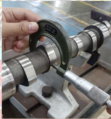
Gambar 3.45 Pengukuran Camlobe camshaft
