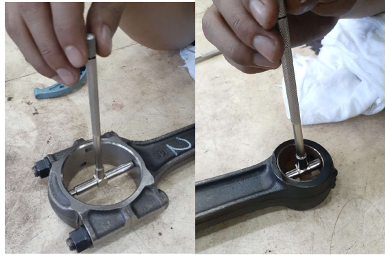
Gambar 3.47 Pengukuran Conneting rod
