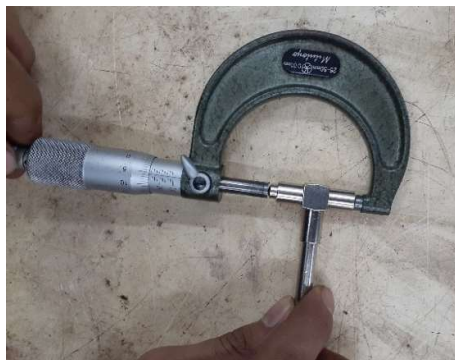
Gambar 3.48 Pengukuran Conneting rod
