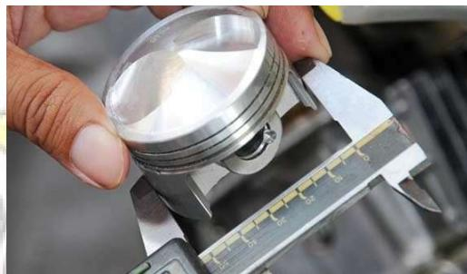
**Gambar 4.13** pengukuran *piston*
