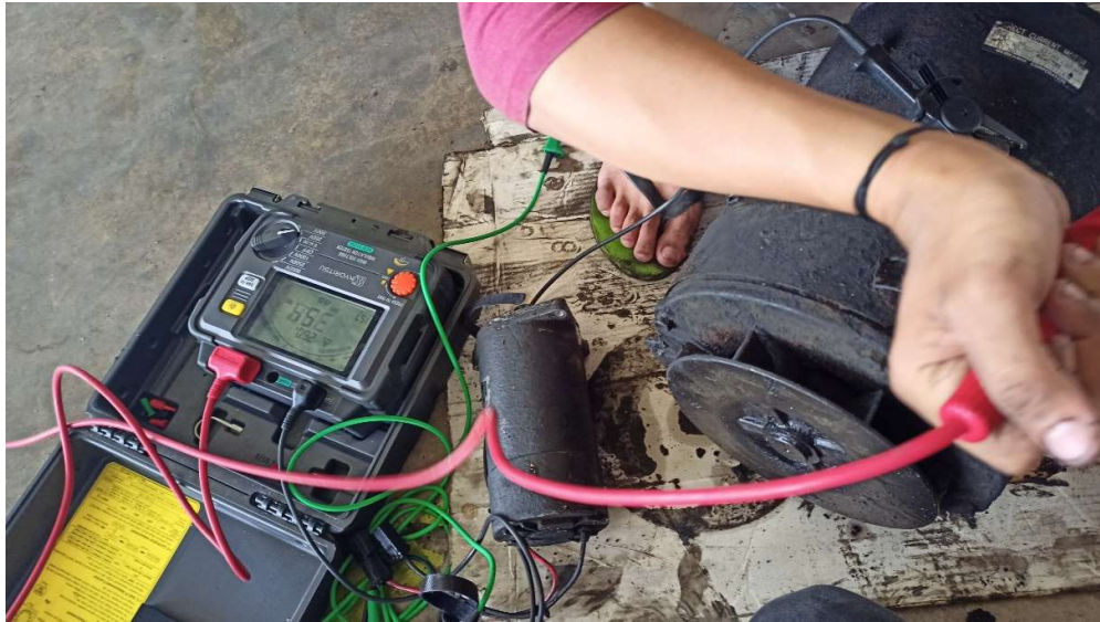
Pengecekan dan Pengujian Motor Travel dan Motor Eps ( magger motor )
