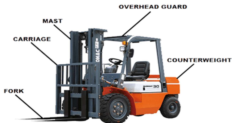
Gambar 2. 3 Bagian Utama Forklift (Sumber: Irfan, 2016)
