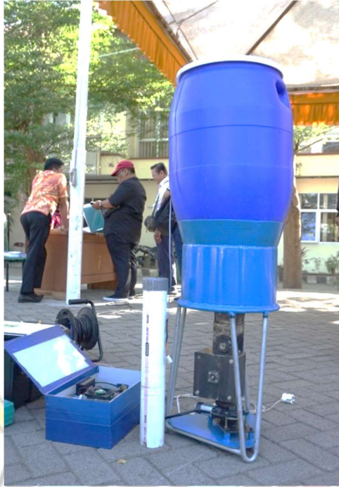
Gambar 2.1 Alat Pelontar Pakan dan Pengukur Level Air Tahun 2019 (Sumber: Abdul Rahmat H.D. dan Yapto Prawira, 2020)
