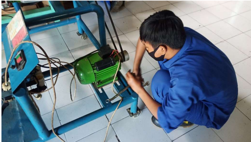
Lampiran 7 Melepas motor listrik pada rangka
