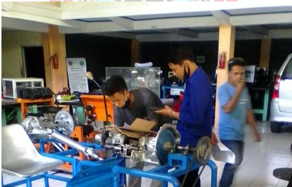
Lampiran 16 Pengambilan data Rpm pada output transmisi
