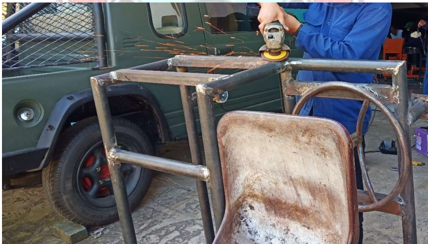
Lampiran 10 Proses mengamplas hasil pengelasan
