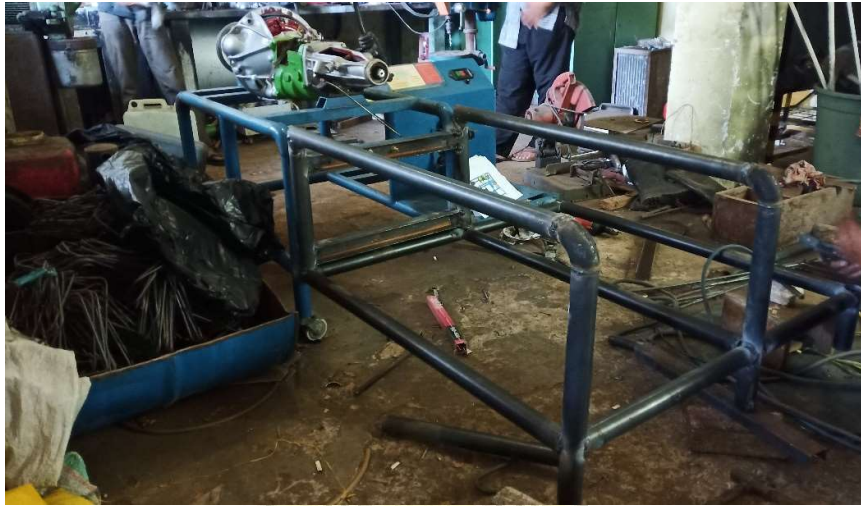
Lampiran 9 Membuat rangka dudukan differential
