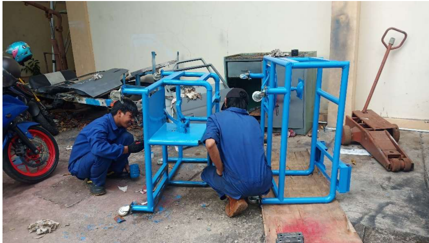
Lampiran 11 Proses mengecat rangka
