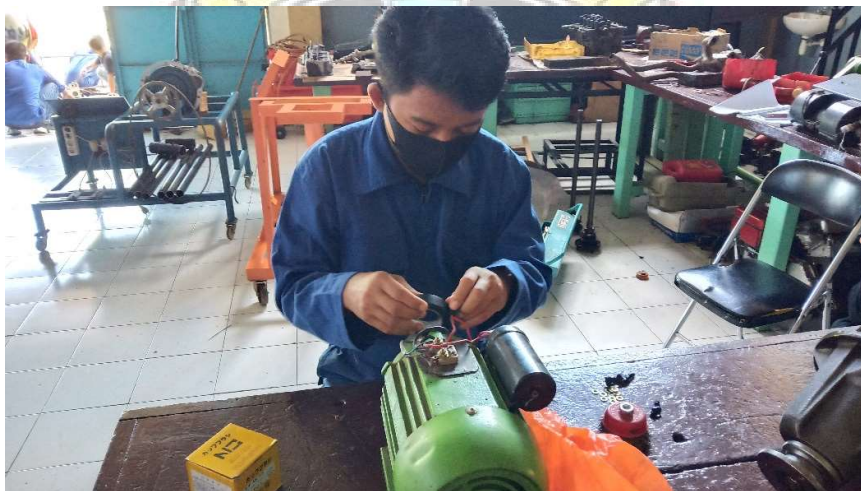
Lampiran 8 Mengganti kabel motor listrik
