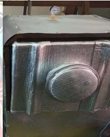
Pemasangan isolasi dan bodi
