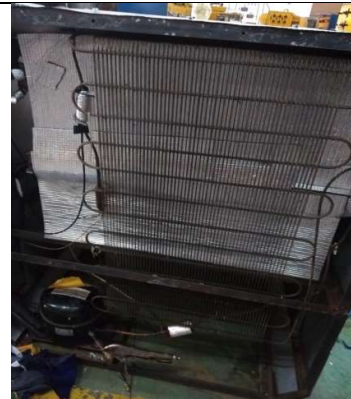
Pemasangan kondensor dan alat ekspansi
