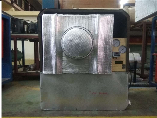
Instalasi pengujian tanpa pompa vakum dan ejector
