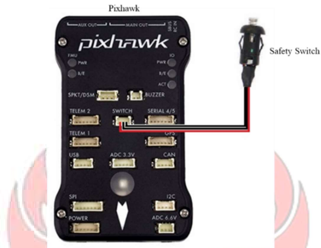
Gambar 3.6 Rangkaian Hubungan antara Flight Controller dan Safety Switch
