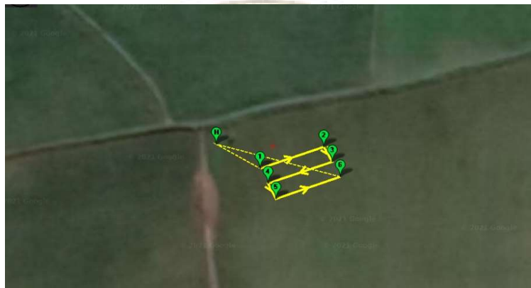
Gambar 4.10 Jalur Terbang yang Drone akan lewati untuk perekaman video
