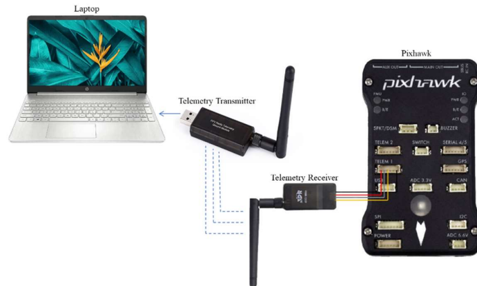
Gambar 3.7 Rangkaian Hubungan antara Flight Controller , Telemetri dan Laptop
