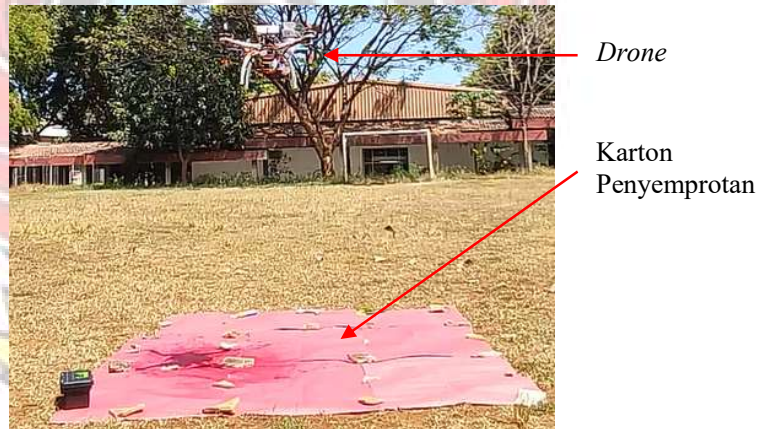
Gambar 4.2 Proses Eksperimen Mekanisme Penyemprotan
