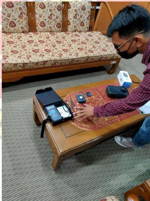
Gambar 15 Pengukuran tingkat pencahayaan ruangan x direktur.
