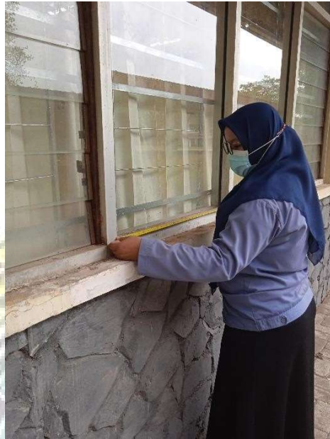
Gambar 18 Pengukuran luas jendela.
