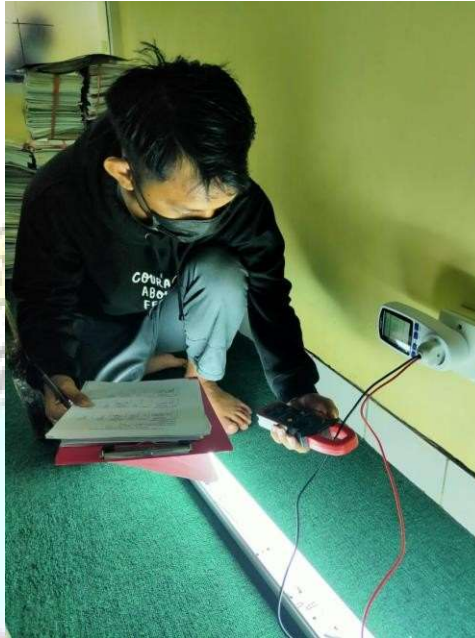
Gambar 12 Pengambilan data Arus dan Cos phi lampu.
