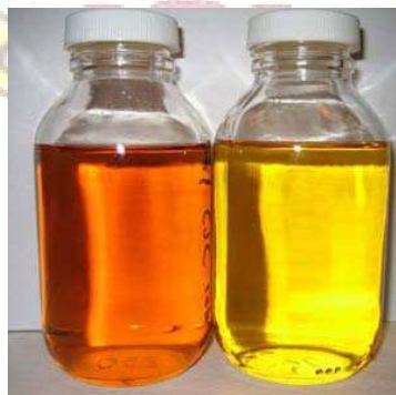
Gambar 2.2 Minyak Isolasi Transformator (Sumber: Transformator Tenaga, PT PLN)
