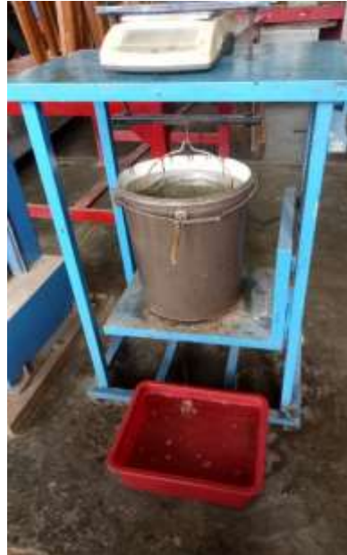
Menimbang Material dalam air
