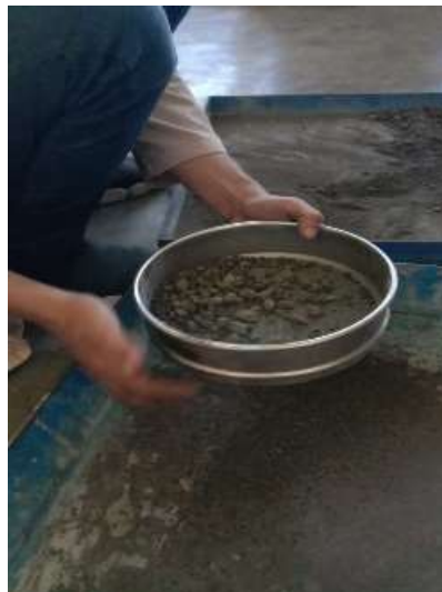
Menyaring material keausan
