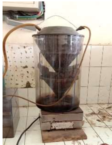
Menuang pelarut CCL 4 dan Menutup Reflux Aspal
