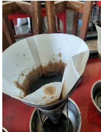
Menuang Material RAP pada dudukan
