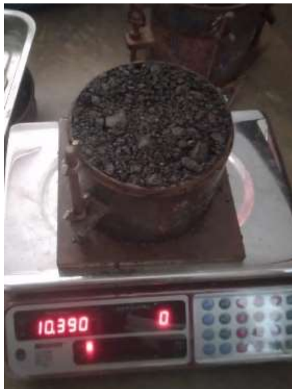
Menimbang sampel yang telah dipadatkan
