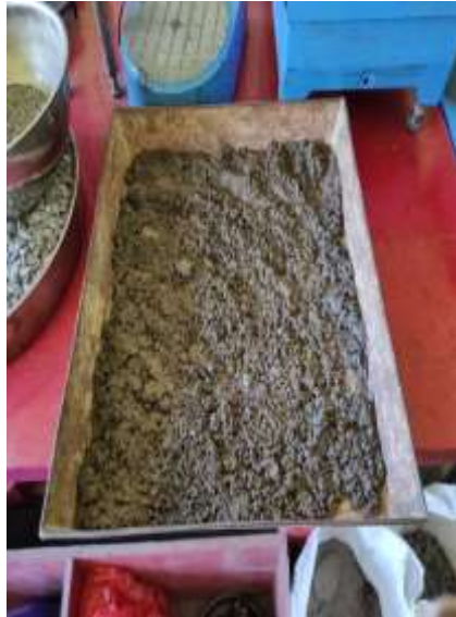
Mengeringkan abu batu dengan kondisi SSD
