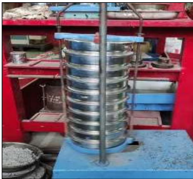
Menjalankan mesin ayakan hingga semua benda uji tersaring
