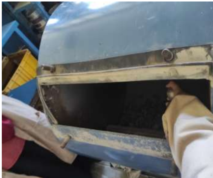
Uji Keausan dengan Mesin Los Angeles
