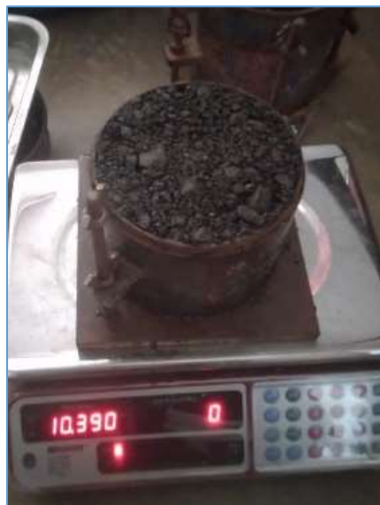
Menimbang sampel yang telah dipadatkan
