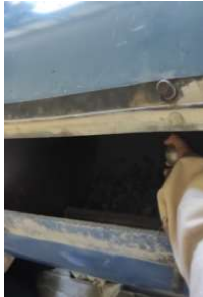
Memasukkan bola baja dan RAP kedalam mesin
