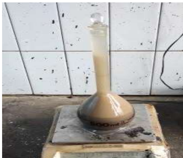
Menimbang berat piknometer + sampel + air
