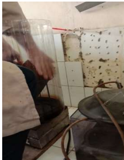
Memasukkan RAP dan Dudukan kedalam Reflux Aspal
