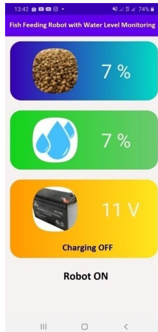
Gambar 5. Screen shoot layar smart phone hasil pemantauan level pakan di tangki penyimpanan, level air, dan level baterai
