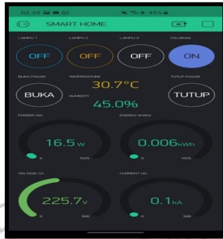
Gambar 4.6 Tampilan menu Blynk saat terhubung dengan prototipe
