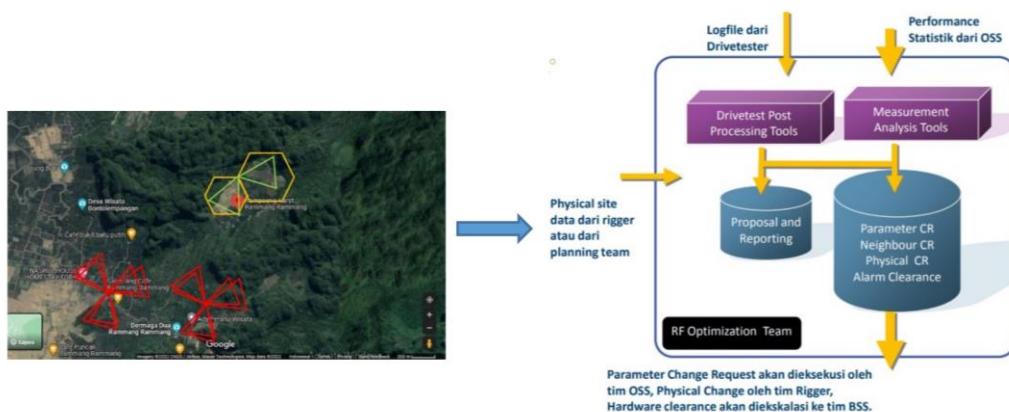
Gambar 1. Target wilayah BTS cell untuk pengukuran Drive/Walking Test (DT/WT). Warna merah adalah wilayah BTS eksis dan Warna Kuning/Hijau adalah wilayah target Wi-Fi 4G
