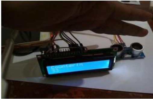
Gambar 8. Hasil pengujian dari penggabungan sensor ultrasonik dan LCD.
