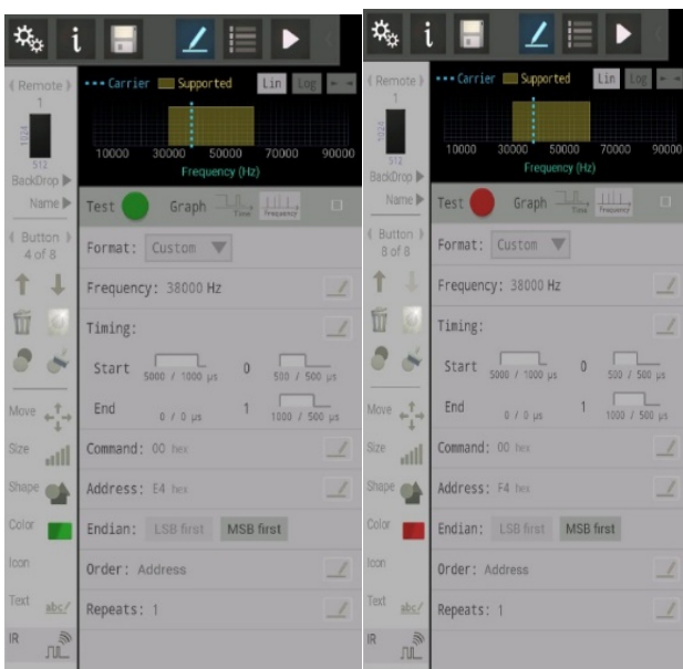
Gambar 7. Konfigurasi Tombol Saklar 4 ON dan OFF.
