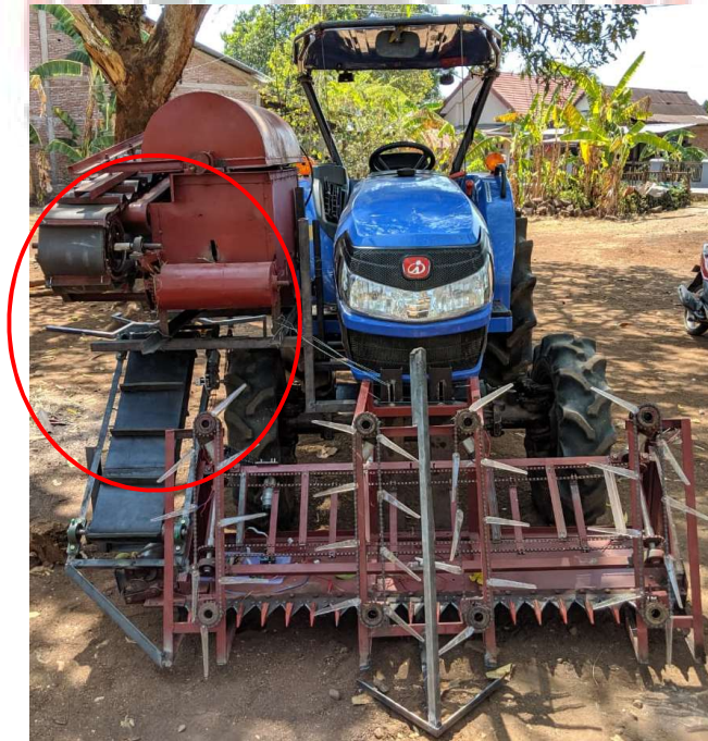
Gambar 4.14 Pemasangan dengan Sistem Pemotong Padi
