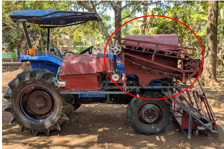
Gambar 4.13 Pemasangan Sistem Perontok Padi pada Traktor
