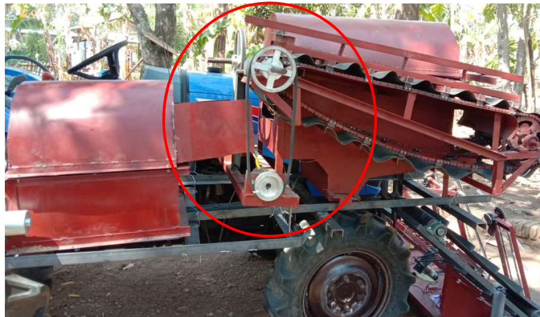
Gambar 4.15 Pemasangan dengan Sistem Pemotong Jerami
