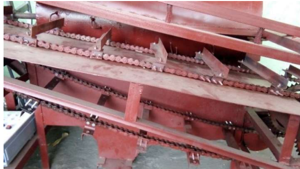
Gambar 4.10 Bagian Konveyor Sistem Perontok
