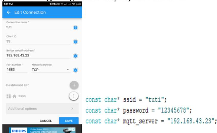
Gambar 13. Pengaturan IP Address pada ESP32 dan *Smartphone*.
