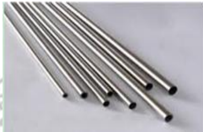
Gambar 2.14 Pipa Hot Dip Galvanis (Sumber: PT PLN (Persero) UP3 NABIRE, 2021)
