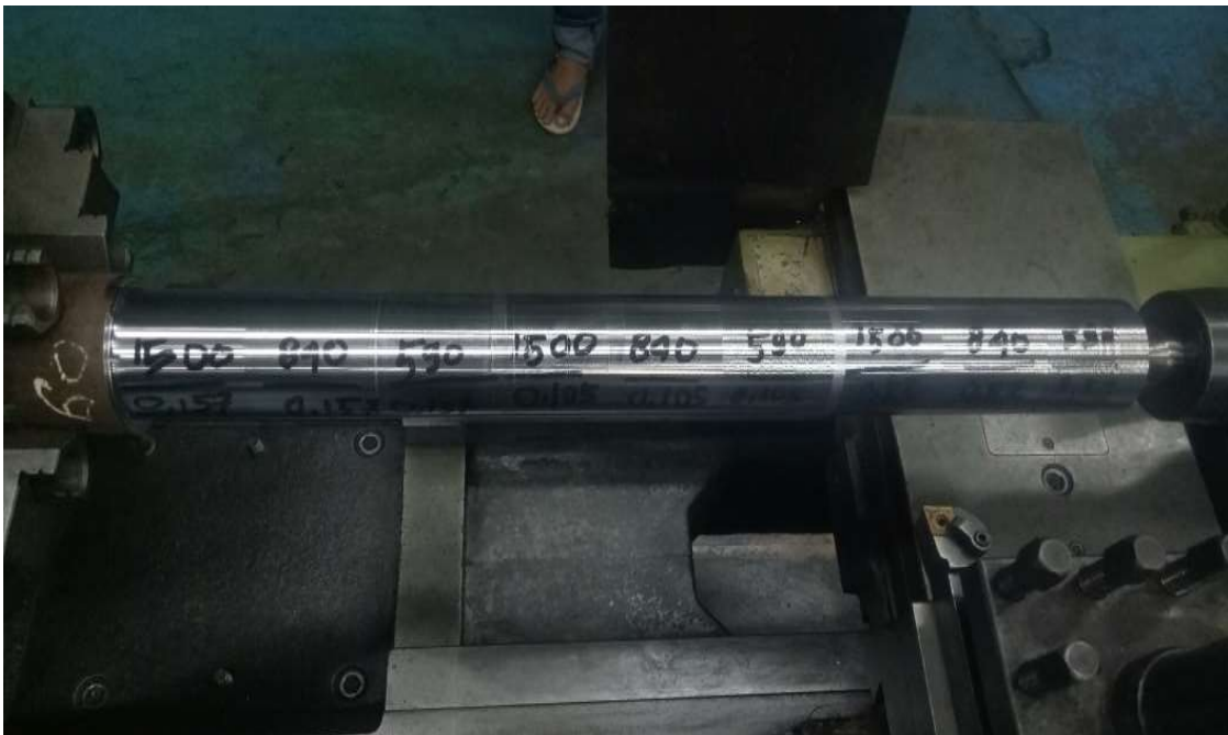
Gambar 4.9 Tampilan Kekasaran Permukaan hasil Pembubutan Baja ST60 MQL
