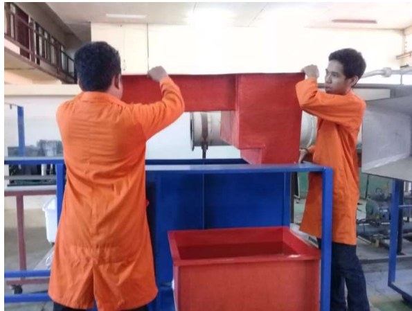
Pemasangan saluran terbuka pada rangka
