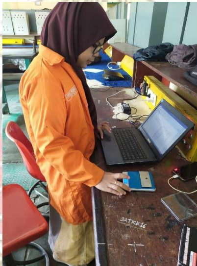
Menimbang benda uji sebelum dipasang pada alat pengujian
