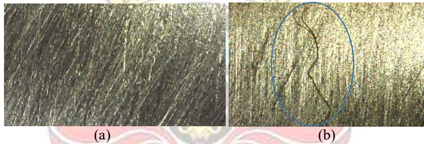
Gambar 4.3 Pengujian material stainless steel dengan konsentrasi air : pasir 90 : 10 % untuk pengujian ke-3 (a) sebelum pengujian (b) sesudah pengujian
