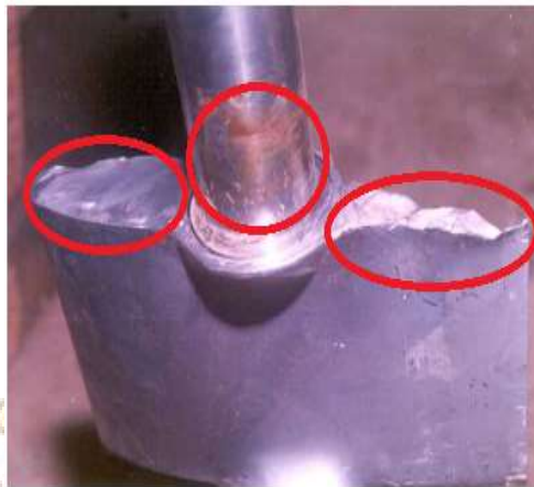
Gambar 2.16 Aus yang terjadi pada sudu pengarah
