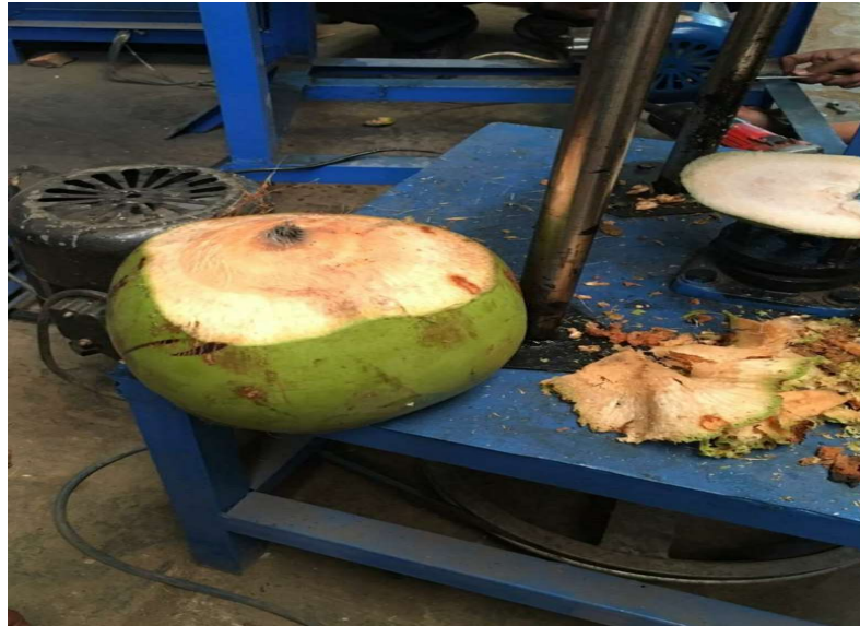
Hasil pengupasan kulit kelapa muda tanpa pemakanan samping
