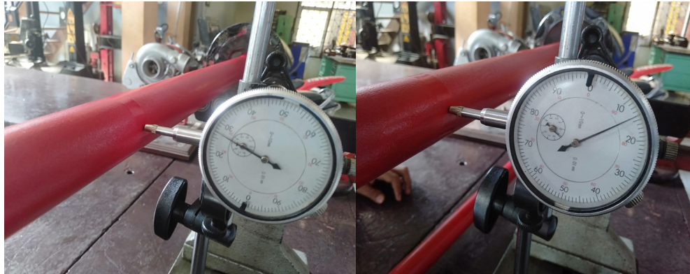
Gambar 4.7 Mengukur kebengkokan poros roda
