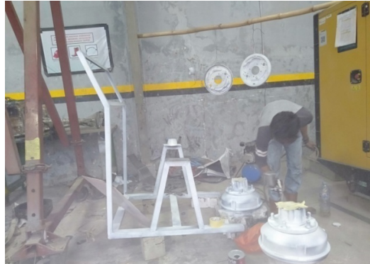
Gambar 7. Proses pengecatan warna dasar
