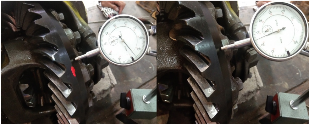
Gambar 4.5 Hasil pengukuran keolengan Ring Gear
