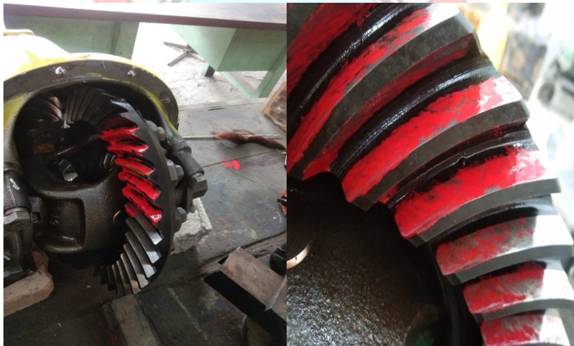
Gambar 4.6 Memeriksa perkaitan antara roda gigi ring dan drive pinion
