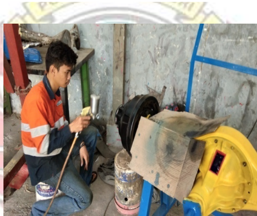
Gambar 8. Proses pengecatan setiap komponen
