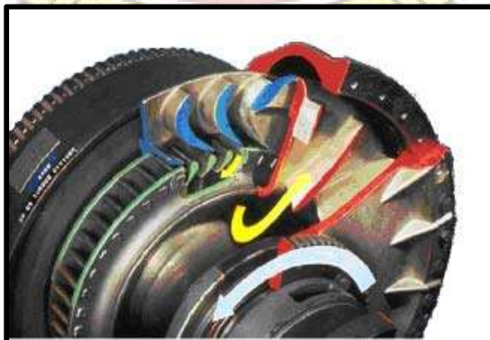
Gambar 2.9 Cara kerja Stator
