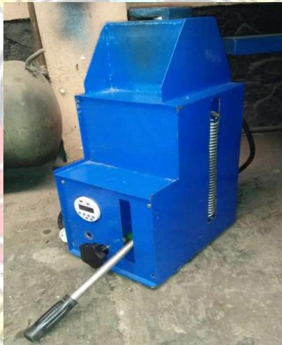
Gambar 4.2 Alat *Hot Mounting* Spesimen Uji Metalografi
