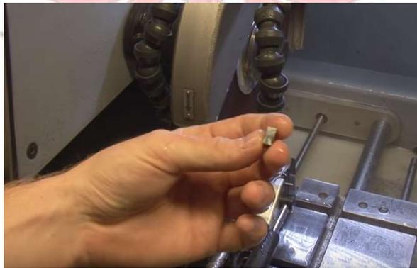
Gambar 2.1 Pemotongan Sampel (*Materials Science 2000: 2014*)
