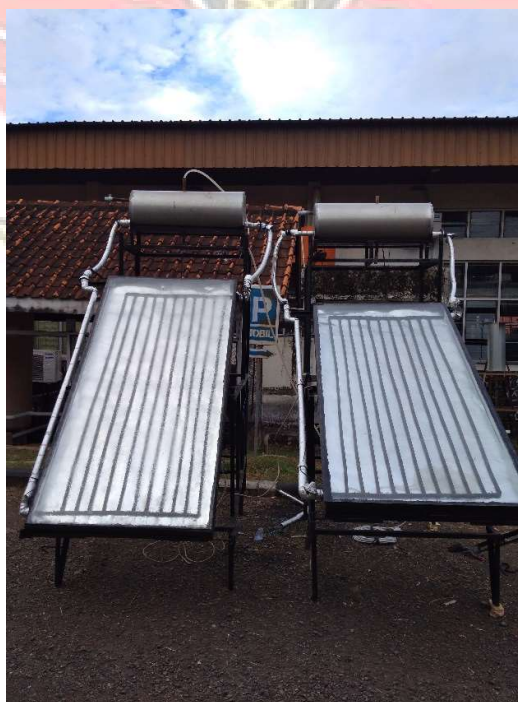
Posisi Kolektor pada Pengujian Hari Kedua dan Ketiga dengan Sudut Kemiringan 45° dan 30 °
