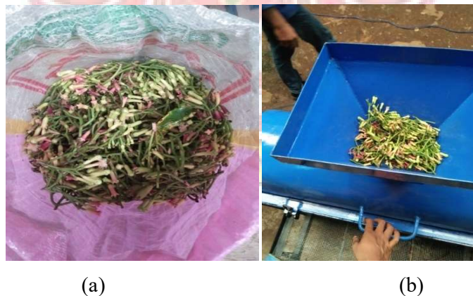
Gambar 4.3 (a) Cengkeh yang telah dipetik, (b) Proses pemasukan cengkeh kedalam corong.
