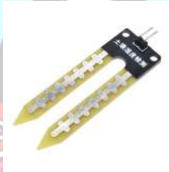
Gambar 4. Sensor Kelembaban Tanah Jenis YL-69
