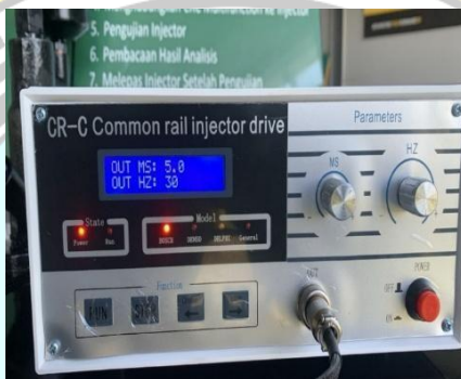
Gambar 3. 14 Mengatur MS dan HZ Sesuai Spesifikasi Injector
