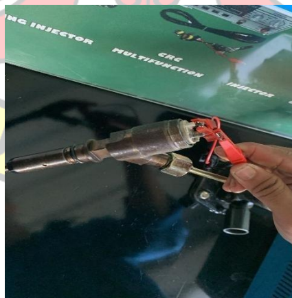
Gambar 3. 12 Menghubungkan Ujung Kabel CRC ke Solenoid Injector
