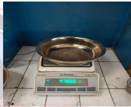
Gambar 3.4 Timbang masing-masing material yang tertahan didalam saringan
