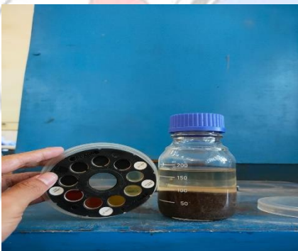
Gambar 10.3 Cocokkan warna benda uji dengan palet warna
