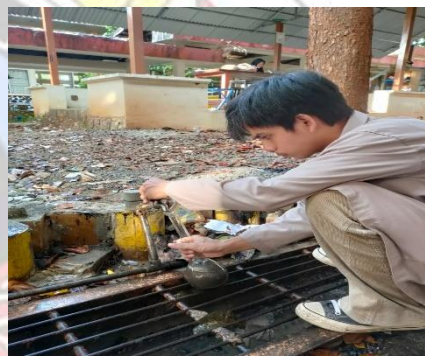
Gambar 6.4 Masukkan benda uji kedalam piknometer kemudian masukkan aquades setelah itu tambah air sampai batas standar
