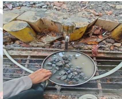
Gambar 2.4 Cuci dan saring benda uji sampai airnya jernih
