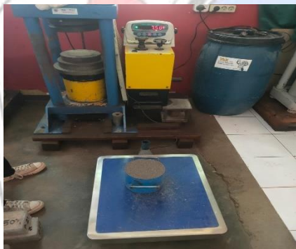
Gambar 5.3 Masukkan material kedalam mold sebanyak 3 lapis dan tumbuk menggunakan tongkat pemadat sebanyak 25 kali
