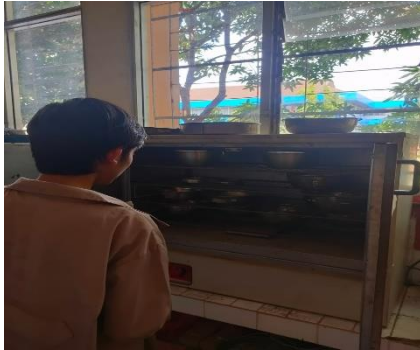
Gambar 8.1 Siapkan material kemudian timbang lalu masukkan kedalam oven
