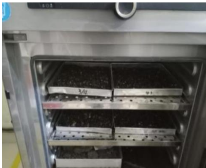
Gambar 2.5 Agregat yang telah dicuci kemudian di masukkan kedalam oven
