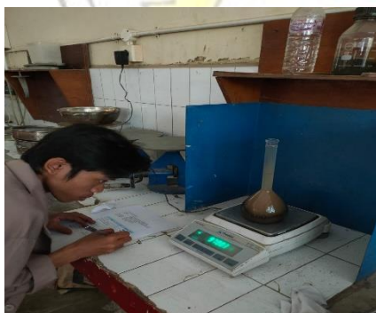
Gambar 6.5 Timbang piknometer yang berisi sampel
