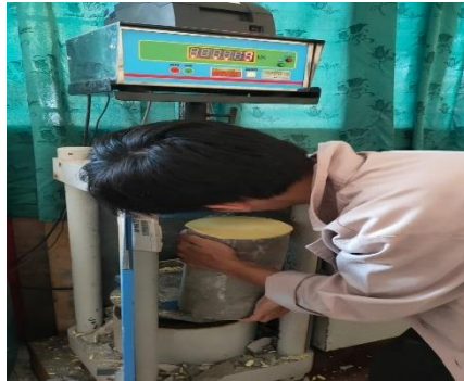
Gambar 12.11 Masukkan sampel beton kedalam mesin uji tekan
