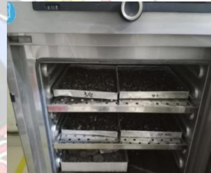
Gambar 7.4 Masukkan sampel kedalam oven sampai berat tetap dan timbang sampel yang telah kering
