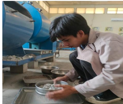
Gambar 11.8 Saring sampel menggunakan saringan 12 dan butiran yang tertahan dicuci
