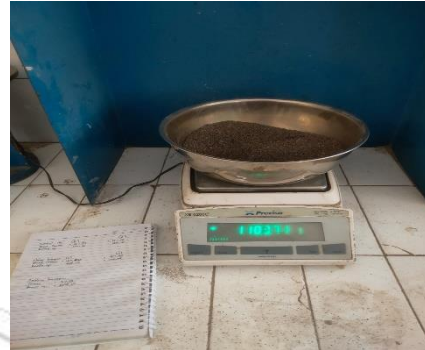
Gambar 8.2 Keluarkan sampel dari oven lalu timbang sampel kondisi kering
