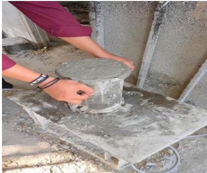
Gambar 12.6 Getarkan campuran beton diatas mesin penggetar
