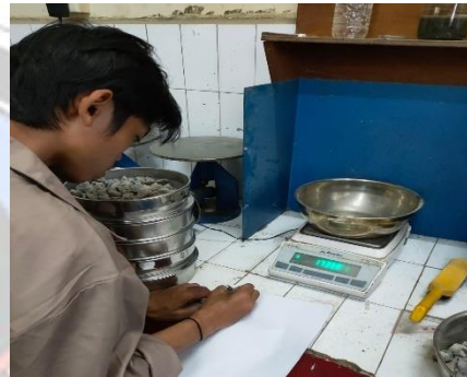
Gambar 4.4 Timbang masing-masing material yang tertahan kemudian catat hasil timbangan
