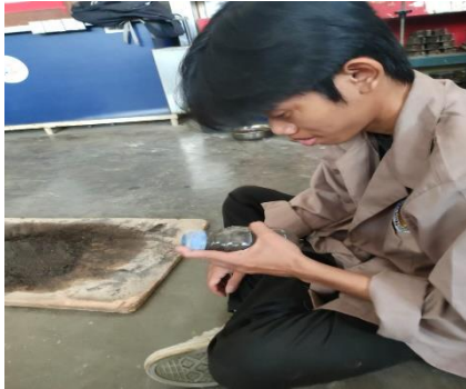
Gambar 10.1 Ambil sampel kemudian masukkan kedalam botol dengan menambahkan larutan NaOH, guncang hingga homogen
