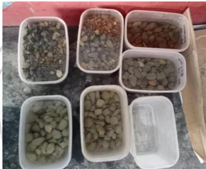
Gambar 2.3 Rendam benda uji selama 24 jam
