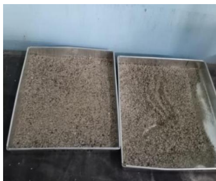
Gambar 1.5 Keluarkan dari oven lalu timbang agregat
