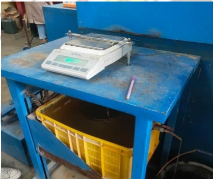
Gambar 7.3 Mengisi dunagan dengan air kemudian memasang timbangan lalu masukkan sampel
