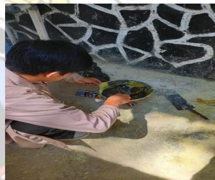
Gambar 12.8 Memasak sulfur yang akan digunakan dalam proses capping
