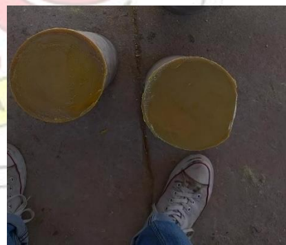
Gambar 12.10 Sampel yang telah dicapping
