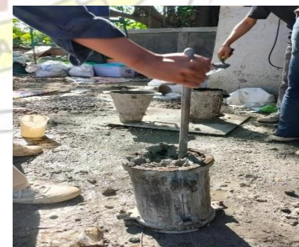
Gambar 12.5 Menumbuk sampel 25 kali per lapisan sebanyak 3 lapis
