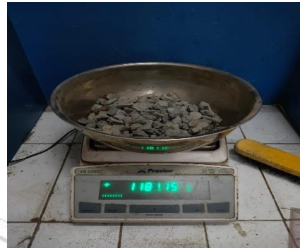
Gambar 4.2 Timbang material yang sudah dioven lalu cuci
