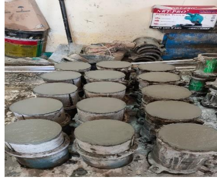
Gambar 12.7 Diamkan campuran beton hingga 24 jam
