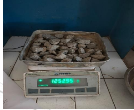
Gambar 9.2 Keluarkan sampel dari oven lalu timbang sampel kondisi kering
