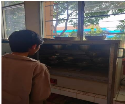
Gambar 4.1 Siapkan benda uji lalu masukkan ke dalam oven
