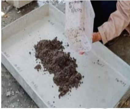
Gambar 6.1 Keringkan material yang telah direndam dengan cara menebarkan diatas permukaan
