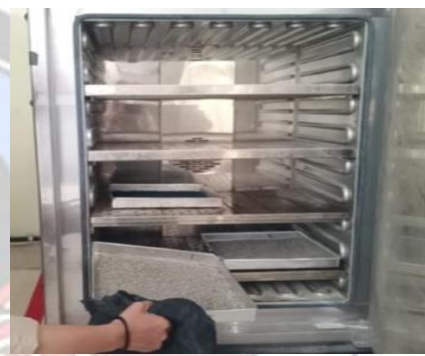
Gambar 1.4 Masukkan agregat yang tertahan kedalam oven
