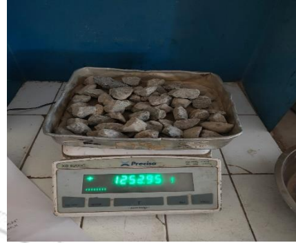
Gambar 7.2 Timbang benda uji yang telah dikeringkan
