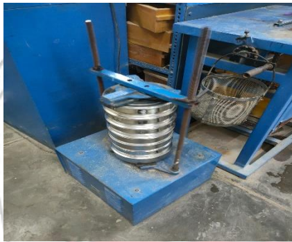
Gambar 3.3 Siapkan saringan no. 4,8,16,30,50,100,200 dan PAN kemudian masukkan material lalu mulai penyaringan
