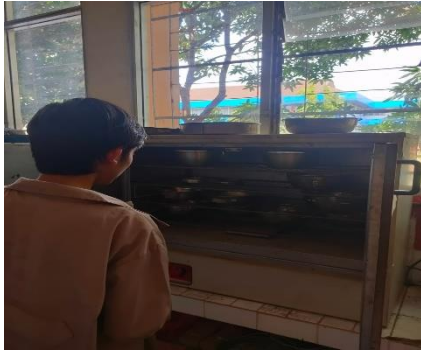
Gambar 3.1 Siapkan benda uji lalu masukkan ke dalam oven
