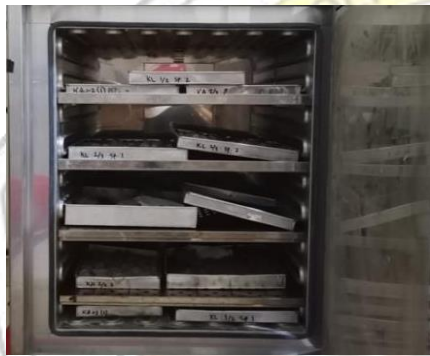
Gambar 11.9 Oven sampel yang telah dicuci
