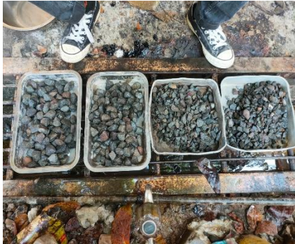
Gambar 11.1 Siapkan benda uji sesuai gradasi lalu cuci dan bersihkan material
