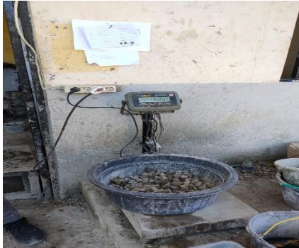
Gambar 12.1 Menimbang semua material yang akan digunakan
