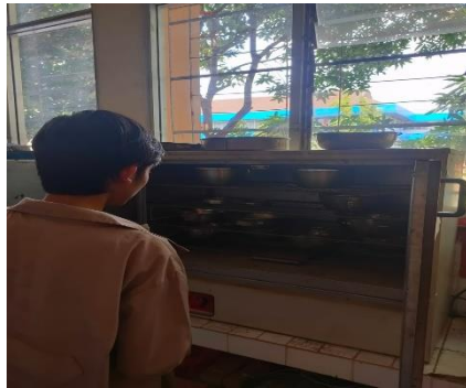
Gambar 5.1 Masukkan material kedalam oven
