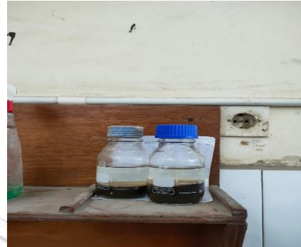
Gambar 10.2 Tutup botol lalu diamkan selama 24 jam dan perhatikan warna sampel uji
