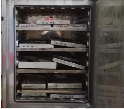
Gambar 9.1 Siapkan material kemudian timbang lalu masukkan kedalam oven
