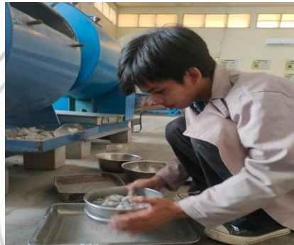
Gambar 4.3 Ayak material pada saringan
