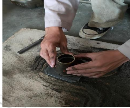
Gambar 6.2 Lakukan pengujian kerucut untuk mengecek SSD
