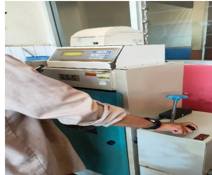
Gambar 12.11 Putar tuas mesin kuat tekan jika benda uji sudah retak
