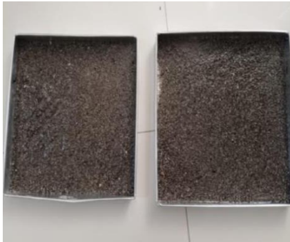
Gambar 6.7 Keluarkan benda uji yang telah dioven lalu dinginkan dan timbang beratnya
