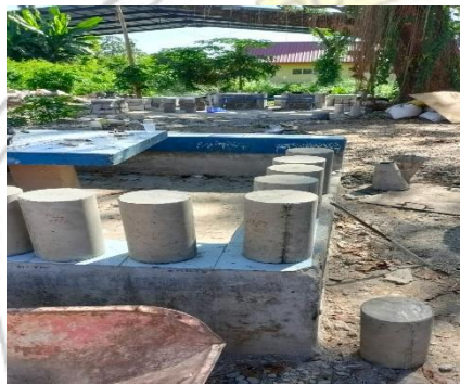
Gambar 12.7 Buka beton yang ada didalam mal kemudian rendam selama 28 hari
