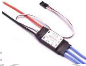
Gambar 2.8 ESC tipe 30A Motor BLDC
