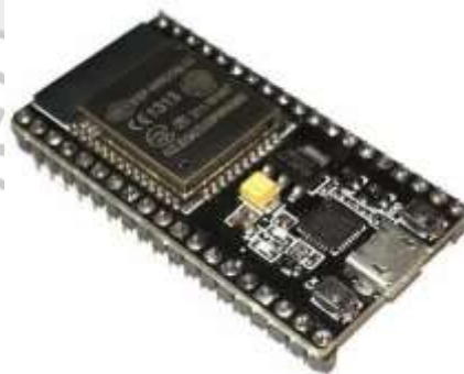
Gambar 2. 2 Bentuk fisik Modul ESP32 DEVKIT V1
