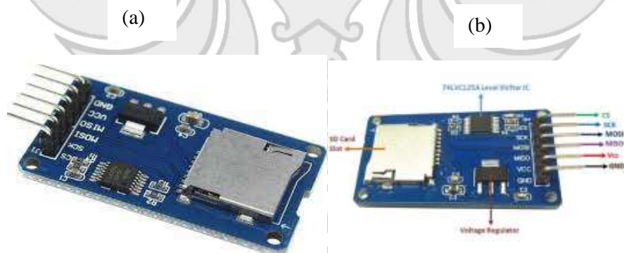
Gambar 2. 11 (a)Bentuk Modul SD Card dan (b)Struktur Modul SD Card
