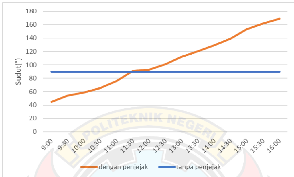
Grafik 4.2 Perbandingan sudut pada panel surya tanpa penjejak dan menggunakan penjejak matahari
