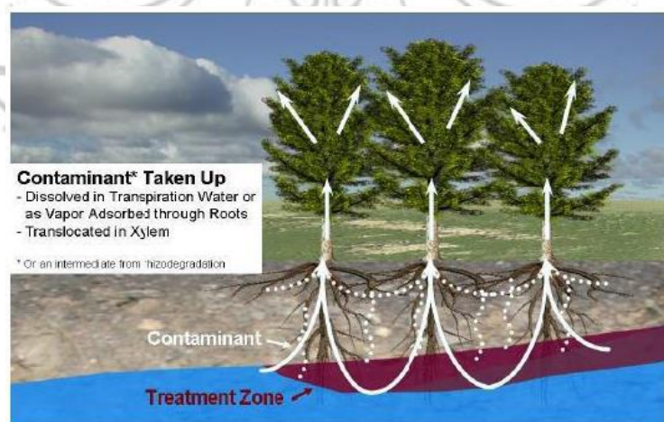
Gambar 2.1 Proses Fitoekstraksi (Sumber: ITRC, 2009)
