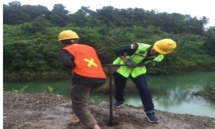
Gambar : Proses pengambilan sampel pada lokasi tambang dengan Handboring
