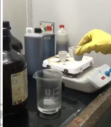
Gambar : penambahan larutan \text{HNO}_3 ( Nitric Acid) pemanasan sampel di atas hot plate
