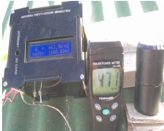
Gambar 16. Pengujian sensor piranometer Tabel 2. Hasil pengujian sensor piranometer
