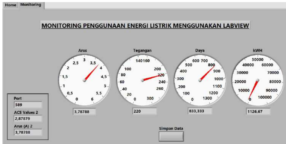
Gambar 8. Tampilan Menu Monitoring pada Pengujian Beban Kombinasi Dispenser, Kipas Angin, Setrika dan Lampu
