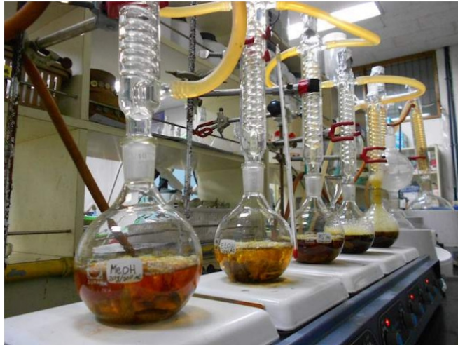
Gambar 2.8. Alat Ekstraksi Refluks Skala Kecil (Nugroho, 2017)
