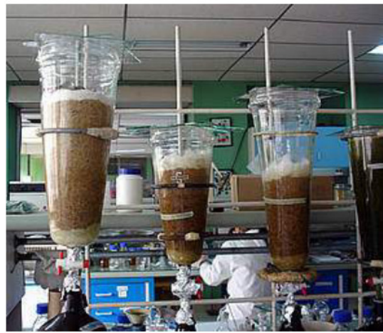
Gambar 2.6. Metode Ekstraksi Perkolasi (Nugroho, 2017)
