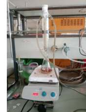
Ekstraksi rimpang jahe dengan metode refluks
