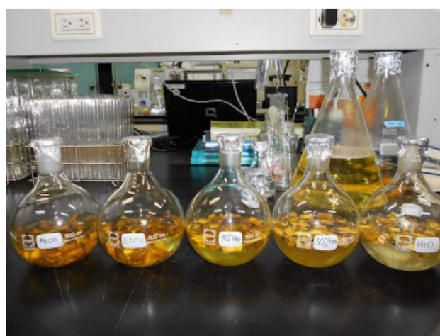
Gambar 2.5. Metode Ekstraksi Maserasi (Nugroho, 2017)
