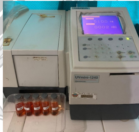
Analisa Fe Menggunakan Spektrofotometer UV-VIS
