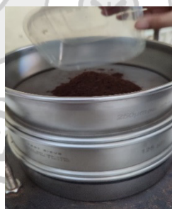
Pengayakan menggunakan alat Seiving 125 mesh
