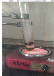
Proses destruksi filtrat hasil ekstraksi
