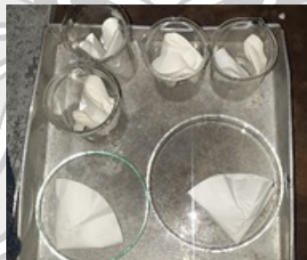
Pemanasan sampel di dalam oven pada suhu 105°C
