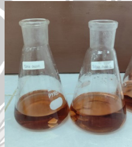
Proses titrasi dengan menggunakan larutan FAS
