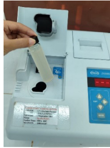
Pengujian kekeruhan menggunakan alat Turbidimeter
