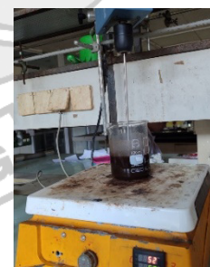
Ekstraksi bubuk pepaya menggunakan larutan NaCl pada v = 150 \text{ rpm} ; T = 50^\circ\text{C} ; t = 1 \text{ Jam}
