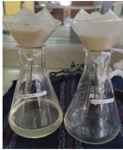
Penyaringan untuk memisahkan residu dan filtrat
