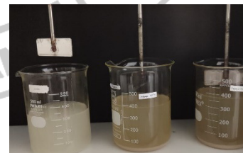
Proses sedimentasi t = 1 \text{ Jam}
