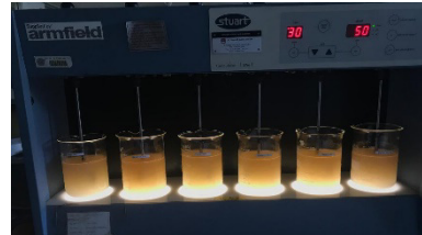
Proses jar test pada biokoagulan biji pepaya
