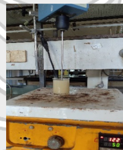
Ekstraksi bubuk kelor menggunakan larutan NaCl pada v = 150 rpm; T = 50^\circ\text{C} ; t = 1 Jam
