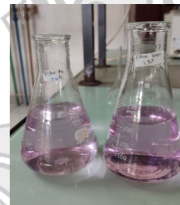
Proses titrasi dengan menggunakan larutan HCL 0,1 N
