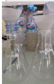
Penyaringan sampel dengan menggunakan kertas saring whatman
