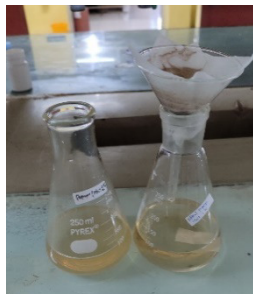
Penyaringan untuk memisahkan residu dan filtrat
