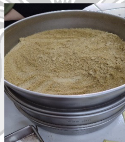
Pengayakan menggunakan alat Seiving 125 mesh
