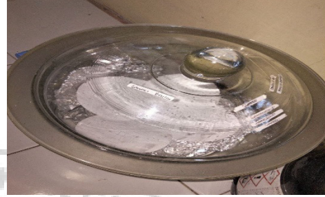
Kertas Saring didinginkan dalam Desikator
