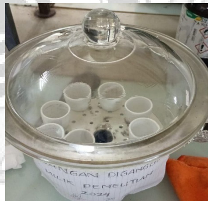
Didinginkan cawan dalam desikator
