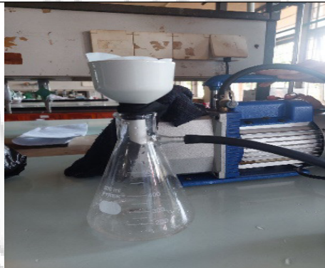
Penyaringan kaleng yang telah dilarutkan dengan Larutan KOH 30%
