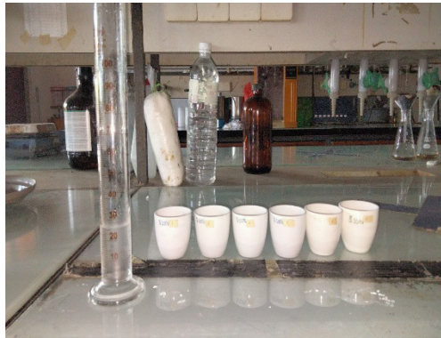
Sampel dimasukkan ke dalam cawan
