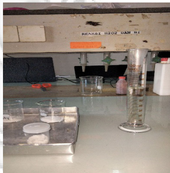
Penambahan air panas sebanyak 75 mL ke dalam sampel
