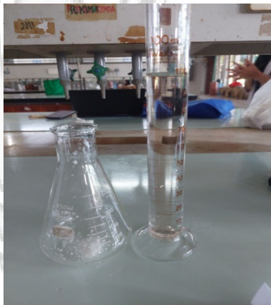
Sampel dilarutkan dengan Aquadest
