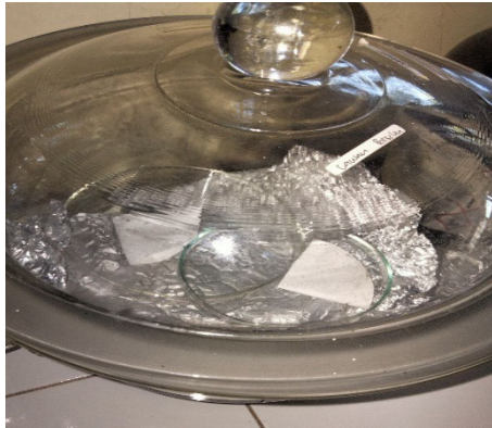
Didinginkan kertas saring + sampel dalam desikator
