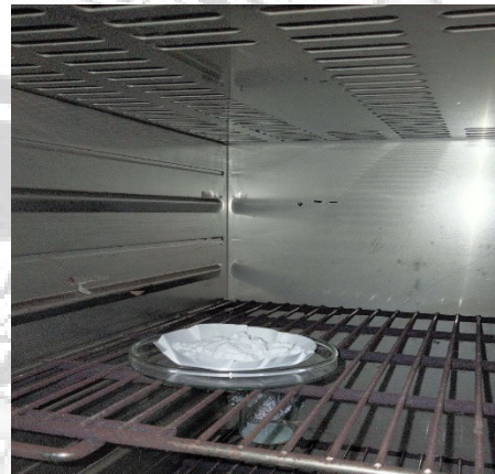
Pemanasan Tawas di dalam Oven
