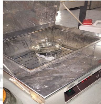
Pemanasan aquadest dalam water bath hingga mendidih
