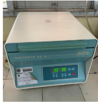
3. Setelah sampel dalam tabung balance, dilakukan sentrifugasi
