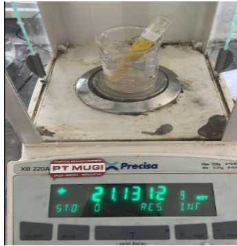
2. Sampel dimasukkan kedalam tabung centrifuge dan timbang
