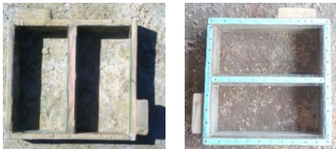
Gambar 1. Alat Tradisional Pencetak Batu Bata
