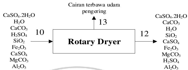
Gambar A. 5 Skema aliran proses pada rotary dryer
