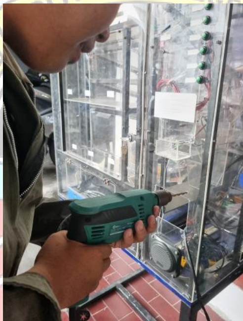
Gambar 4. 2 Proses pemotongan dan pengeboran alat pendeteksi uang kertas
