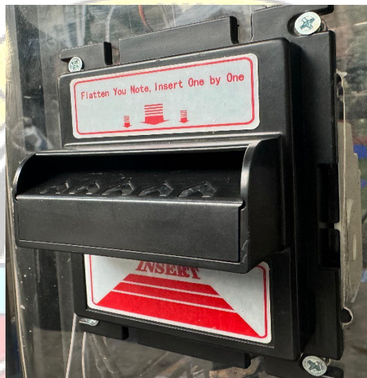
Gambar 4. 5 Pemasangan pendeteksi uang kertas
