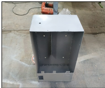
Gambar 4. 3 Pembatas battery pada box komponen
