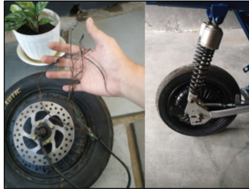
Gambar 4. 6 Motor listrik yang rusak
