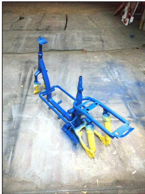
Gambar 4. 1 Pengecatan ulang kerangka sepeda
