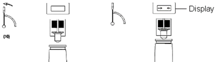
Gambar 3. 57 (a) Handwheel Berputar Keatas; (b) Permukaan Sampel Bersentuhan Penetrator
