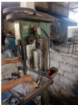
Gambar 3. 38 Pelebaran Lubang Propeller dengan Mesin Bor
