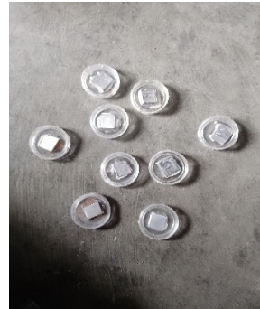
Gambar 3. 46 Hasil Spesimen setelah Dituangkan Cairan Resin dan Hardener
