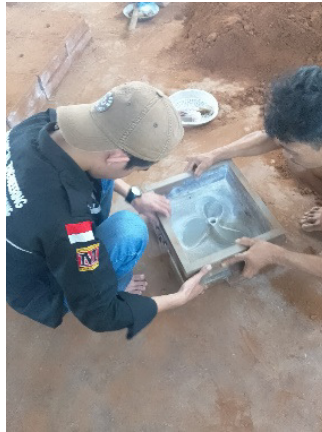
Gambar 3. 22 Pemasangan Initi Cetakan
