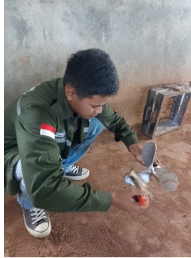
Gambar 3. 37 Pembersihan Propeller setelah Pembongkaran
