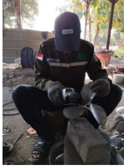
Gambar 3. 39 Meratakan Sisi Propeller dengan Gerinda
