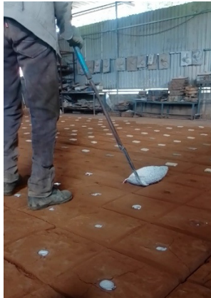
Gambar 3. 35 Penuangan Lelehan Aluminium ke Cetakan
