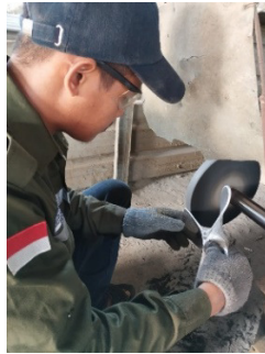
Gambar 3. 40 Menghaluskan Permukaan Propeller dengan Mesin Amplas
