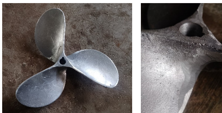
Gambar 4. 1 Cacat porosity pada produk
