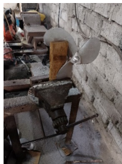
Gambar 3. 41 Pembuatan Alur untuk Lubang Spi
