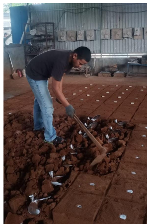
Gambar 3. 36 Pembongkaran Hasil Pengecoran
