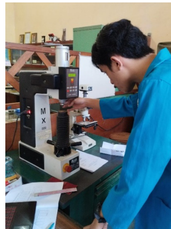
3. Pemasangan penetrator ball 2,5mm
