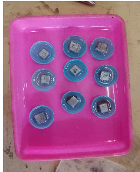
Gambar 3. 46 Hasil Spesimen setelah Dituangkan Cairan Resin dan Hardener
