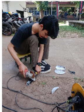
Gambar 3. 44 Pemotongan Spesimen dengan Gerinda
