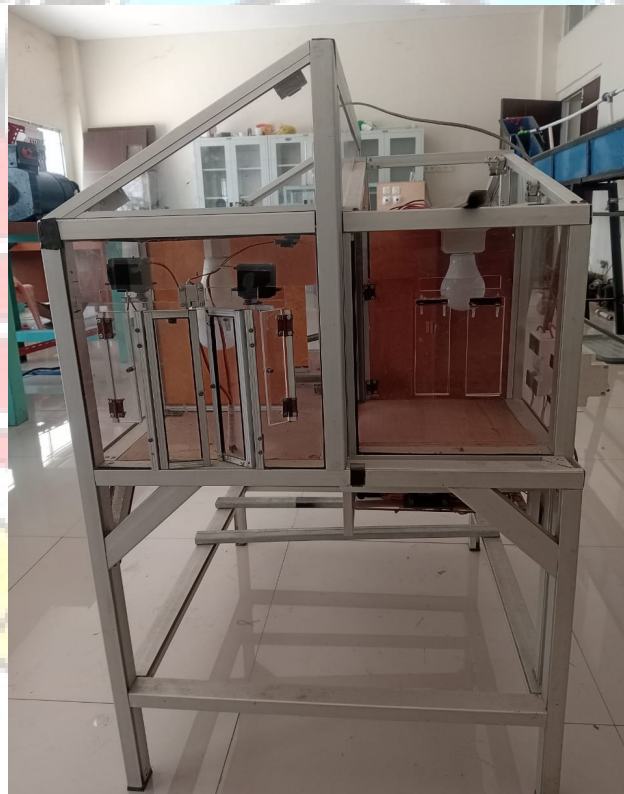
Gambar 4.1 Perancangan rangka pada alat miniatur rumah dengan menggunakan kWh meter digital
