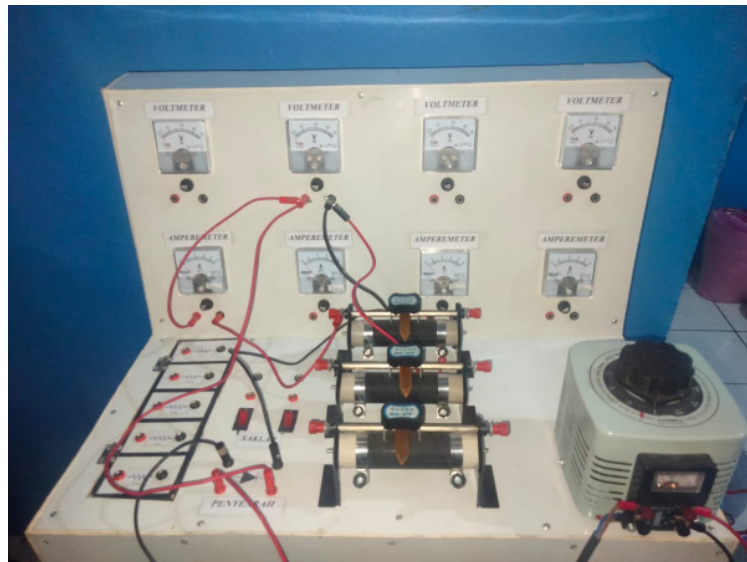
Gambar L8 Rangkaian Hukum Ohm
